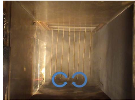
รูปที่ 3 - 3 ลักษณะลมหมุนวนภายใต้สนามไฟฟ้า แรงดันสูง (ก) กรณี 2 (ข) กรณี 3 (ค) กรณี 4
